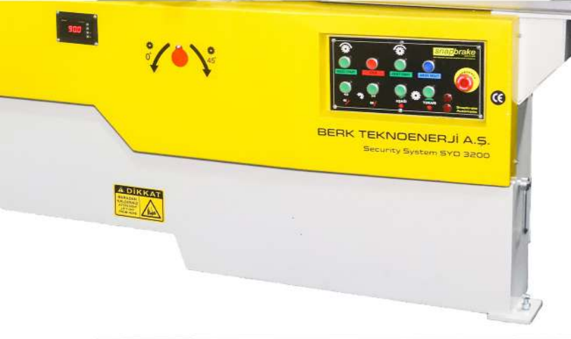
Testereyi 45 ile 90 arasında ayarlama volanı
