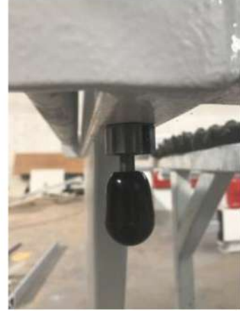
90 derece ayar civatası. Makinenin 45° ayarı tutmuyorsa buradan gevşetilerek ayarlanır.
